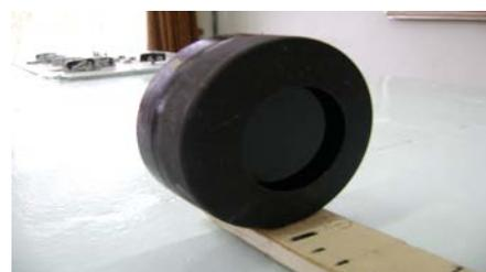
Для выполнения задания ребята сконструировали «визирную линейку». Для этого на стандартную метровую линейку прикрепили фильтр от объектива телескопа, с одной стороны, и миллиметровое стекло с приклеенным к нему чёрным кружком (8мм), с другой стороны. Это стекло можно было передвигать по линейке.
